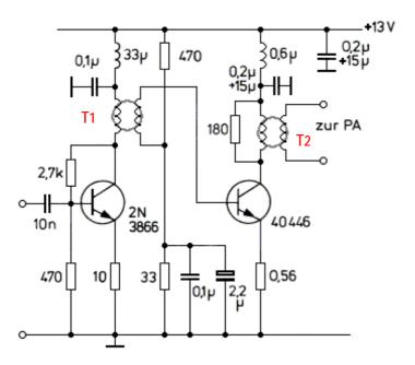
T1 führt zur Basis des zweiten Transistors.
